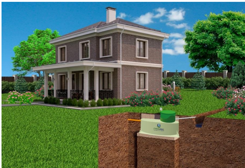
Рисунок 19. Монтаж с принудительным забором воды в фильтрующий колодец (Модели со стандартной высотой корпуса)
